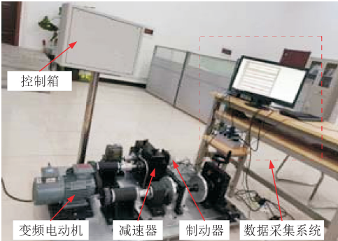
图 2 实验室自测振动平台 Fig. 2 Laboratory self-testing vibration platform
